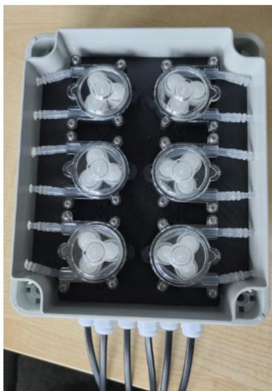
Abbildung 4: Selbstentworfene Pumpenbox mit sechs Peristaltikpumpen
