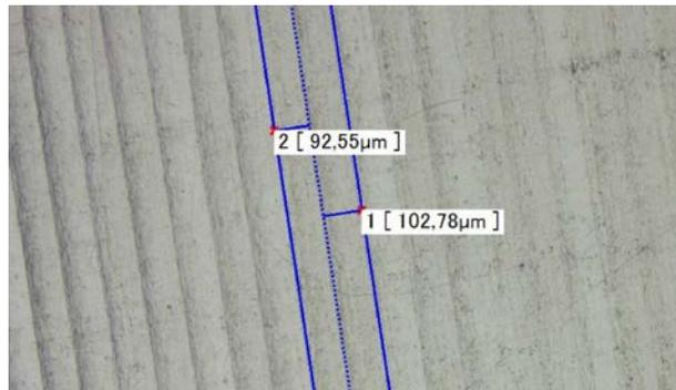
Abb. 10: Glättvorschub an Oberfläche abgelesen unter Lichtmikroskop bei 100facher Vergrößerung nach [2 S. 68]
